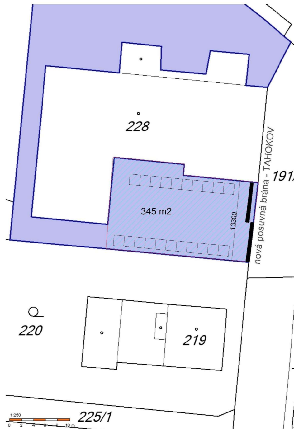
VELIKOST STANOVIŠTĚ A NÁVRH ÚPRAV - POSUVNÁ BRÁNA - OCELOVÁ RÁMOVÁ KONSTRUKCE, VÝPLŇ DĚROVANÝ PLECH TAKOKOV
