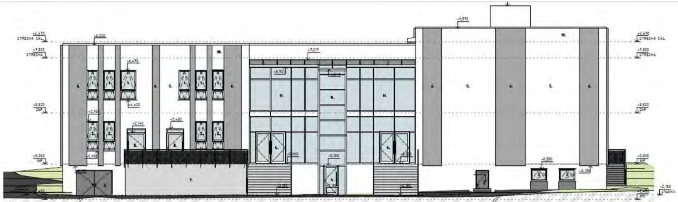
1.PP: řez A, čelní pohled, zleva schodiště, výtah, schodiště, galerie s venkovním posezením
