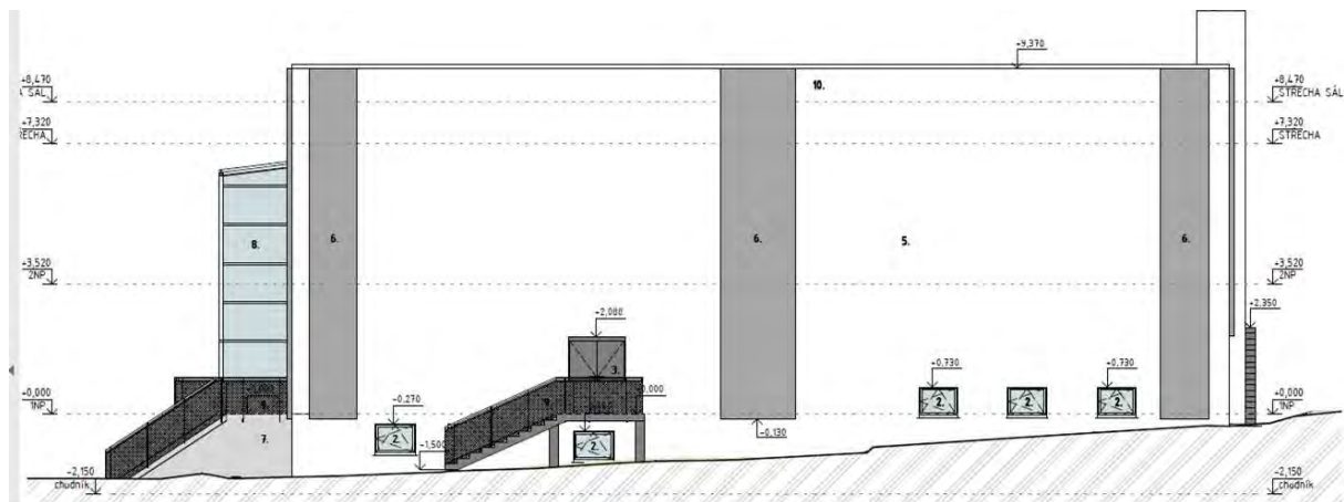
Boční pohled na únikový východ. Úzké sloupky výztuží zdí spojujeme do bloků.
